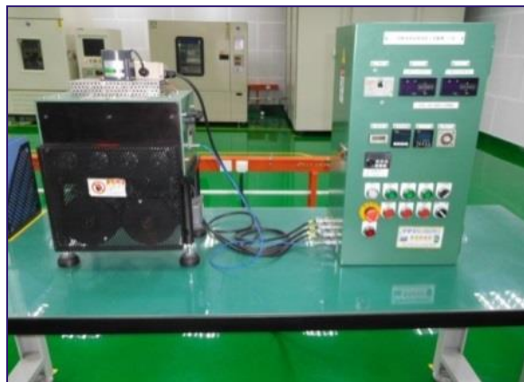
轴承高温高速滑脂试验机
