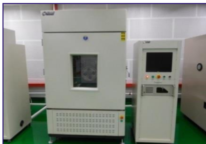
张紧轮试验机(粉尘、盐雾) (低温、防水)
